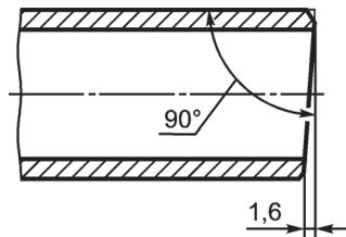
Рисунок 3 — Неперпендикулярность торца трубы
