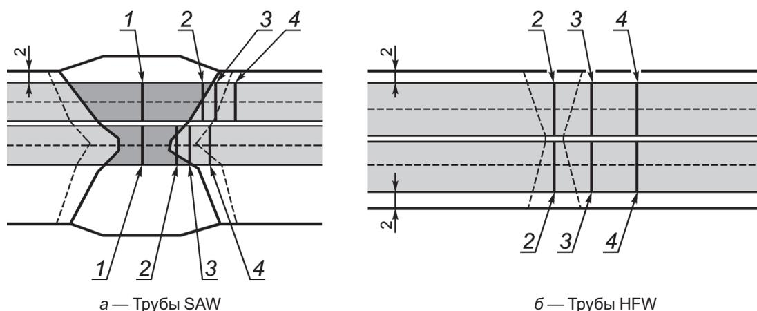
1 — ось надреза, выполняемого на образце для испытания металла сварного шва; 2 — ось надреза по линии сплавления, выполняемого на образце, включающем 50 % металла сварного шва и 50 % зоны термического влияния (HAZ); 3 — ось надреза на расстоянии приблизительно 2 мм от линии сплавления; 4 — ось надреза на расстоянии приблизительно 5 мм от линии сплавления
