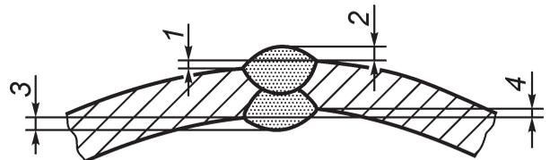
1 — наружное радиальное смещение; 2 — высота наружного валика сварного шва; 3 — высота внутреннего валика сварного шва; 4 — внутреннее радиальное смещение
