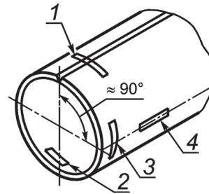
1 — W — поперечная проба со сварным швом по оси пробы; 2 — Т180 — поперечная проба, расположенная приблизительно в 180° от продольного сварного шва; 3 — Т90 — поперечная проба, расположенная приблизительно в 90° от продольного сварного шва; 4 — L90 — продольная проба, расположенная приблизительно в 90° от продольного сварного шва
