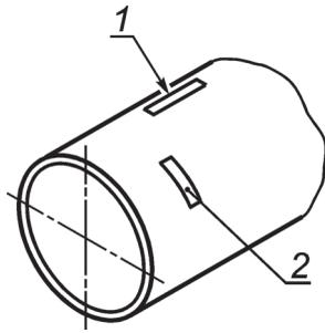
1 — L — продольная проба; 2 — Т — поперечная проба
