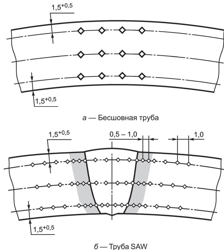
Рисунок 10 — Места контроля твердости по толщине стенки
