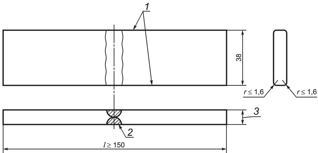
1 — длинные кромки механически обрабатывают и/или отрезают кислородной резкой; 2 — сварной шов; 3 — толщина стенки
